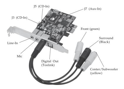
Figure 1: DP SoundWave 5.1 PCIe
